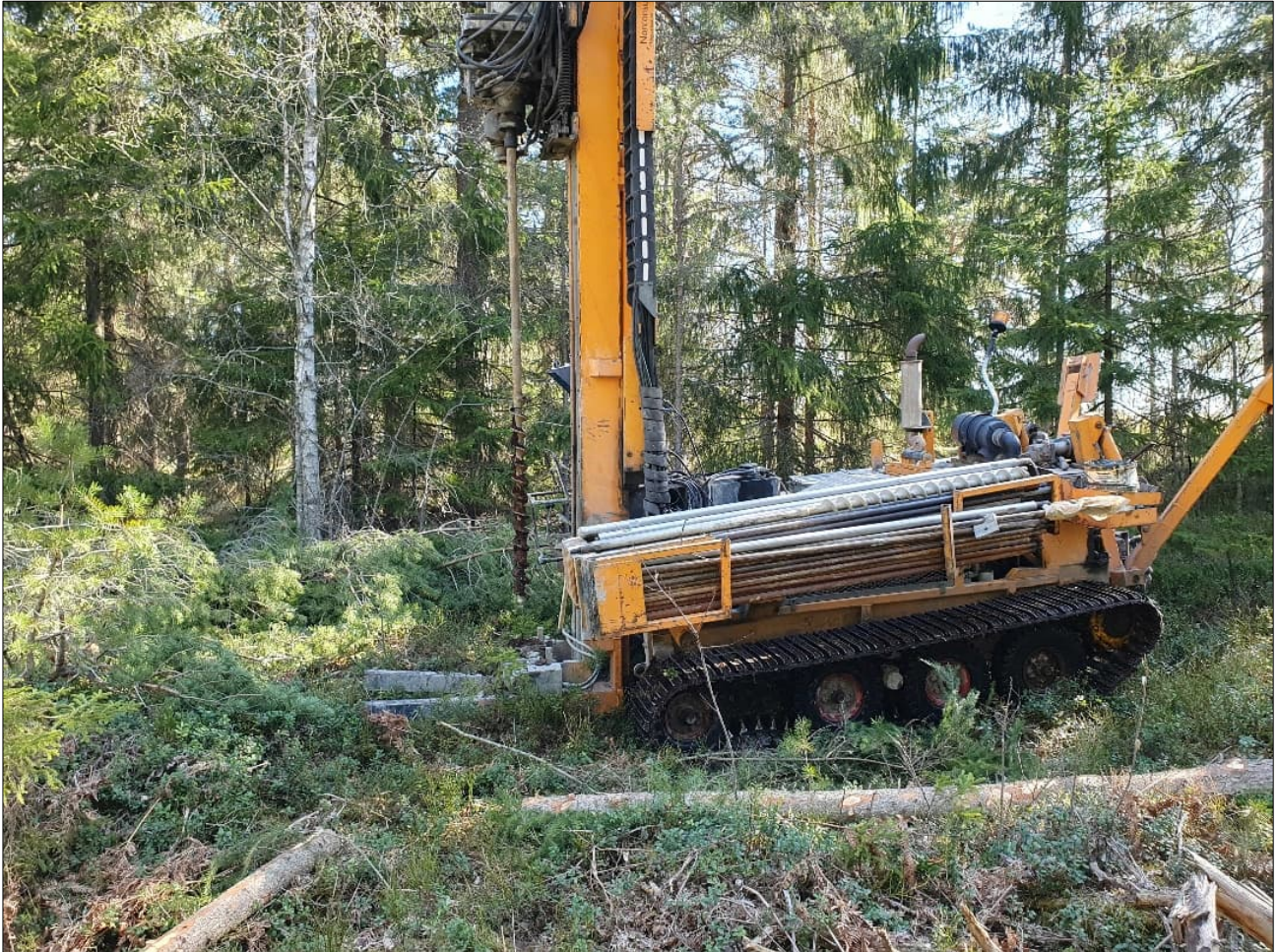
Figur 4. Jordprovtagning utförd med borrhandsvagn i provpunkt NC23.
